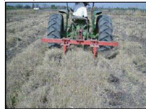
Figura 2. Por sus ventajas el multiarado es considerado una herramienta en la Agricultura de Conservación.
