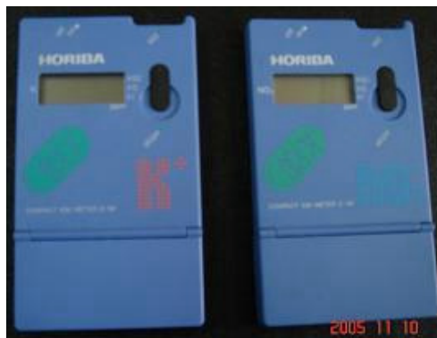
Figura 1. Medidores de Ion selectivo o cardy portátiles para determinar concentración de nitratos y potasio en extracto vegetal.
