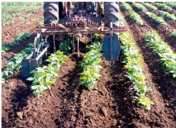
Figura 2. La Pileteadora, implemento que forma montículos de tierra a intervalos regulares a través del surco.
