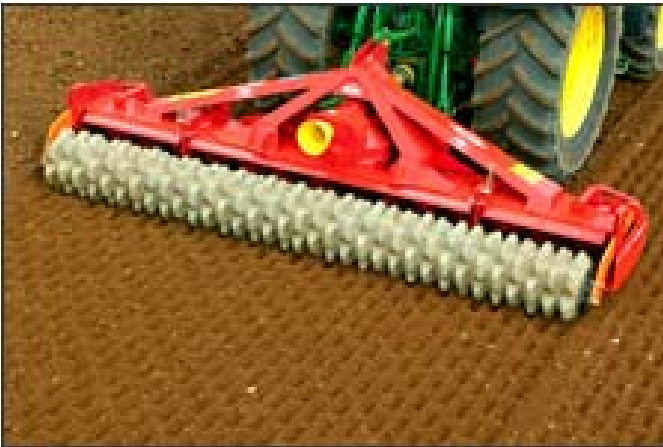
Figura 3. El sistema Aqueel, implemento que forma las microdepresiones sobre la superficie del terreno.
