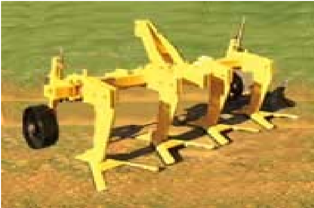
Figura 1. El multiarado, implemento que rotura el suelo sin invertir su perfil.
