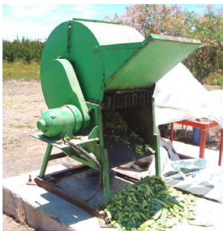
Figuras 10 y 11. Aspecto del nopal picado y prototipo de una picadora de nopal.
